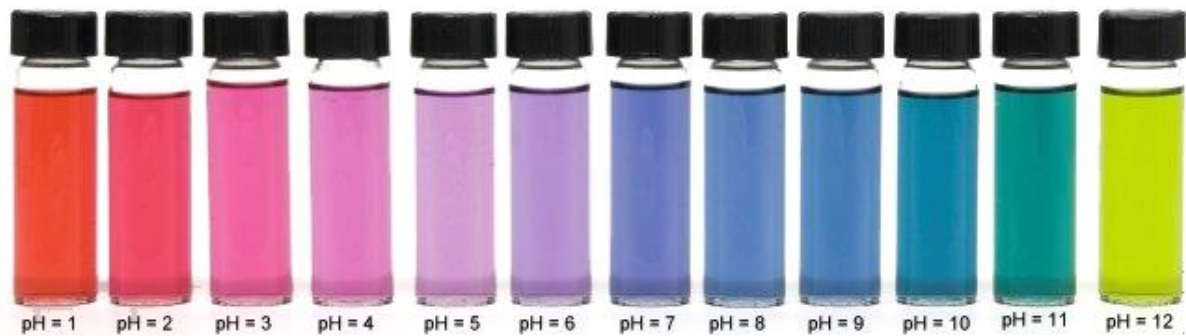
De kleur van rodekoolsap bij verschillende zuurgraden. Links (1-7) is zuur, pH=7 is neutraal, rechts (7-12) is base.
